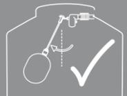
POSICIÓN CORRECTA DEL FLOTADOR
