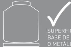
SUPERFICIE PLANA: BASE DE CONCRETO O METÁLICA
