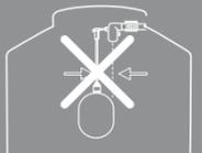
POSICIÓN INCORRECTA DEL FLOTADOR
